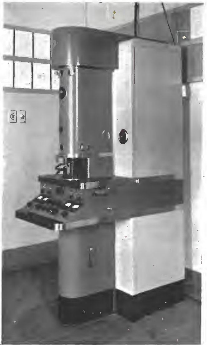
Fig. 3. - Grande microscopio elettronico RCA mod. E.M.U. Un esemplare di questo tipo è attualmente in funzione anche in Italia nell'Istituto Scientifico della Montecatini.
