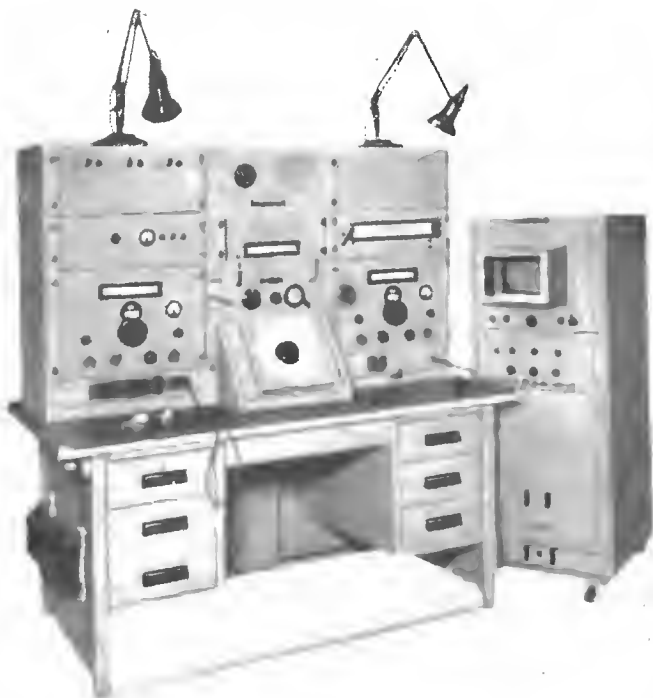
Radiogonometro Marconi Adcock a rilievo oscillografico.
