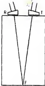
Fig. 1 - Disposizione per l'esame di un materiale secondo il metodo di riflessione.
