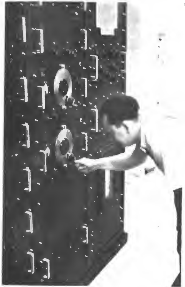
Un particolare del campione primario di frequenza esposto da Ferisol.
