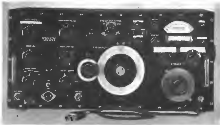
Fig. 8 - Vista frontale di un generatore di segnali campione sperimentale per 50-1000 MHz.
