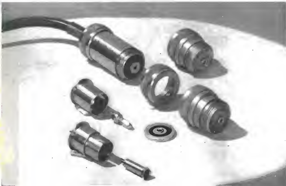
Fig. 21. - Testa di voltmetro o galvanometro a cristallo smontata.
