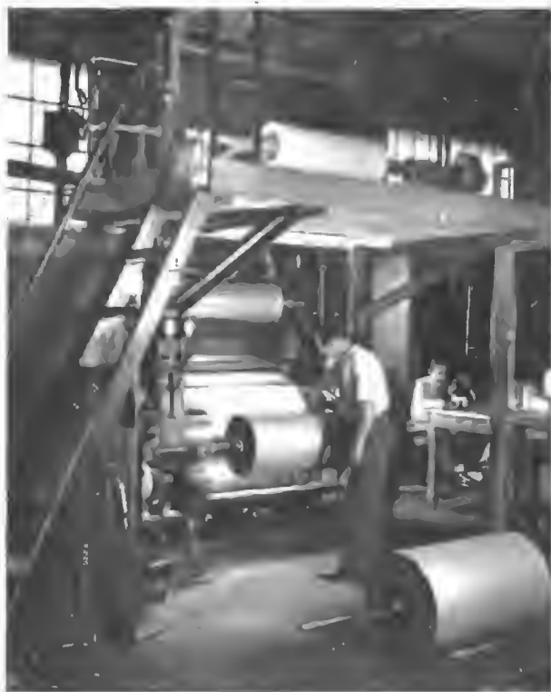
Fig. 8 - Calandra per uniformizzare o ridurre la spessore della carta.
