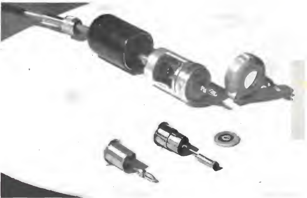
Fig. 22. - Testa di un moderno voltmetro di cresta a diodo smontata.
