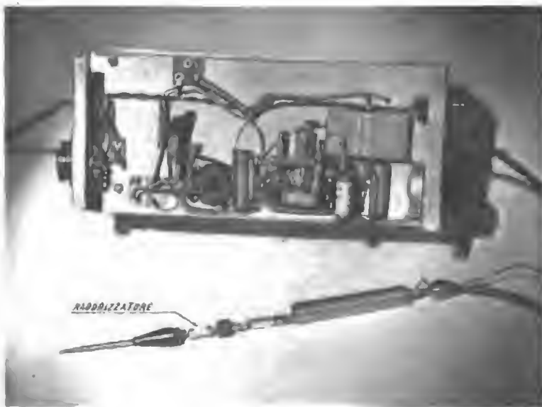
Montaggio della parte inferiore e particolare della "testa esploratrice".
