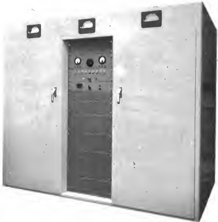
Fig. 2. - Trasmettitore telegrafico ad onde corte da 10 kW, tipo SO 58/10 K caratterizzato dal minimo ingombro e dalla sicurezza di servizio. - Gamma della lunghezza d'onda 14,5-53 m. Cambio della lunghezza d'onda realizzabile in 7 minuti. La parte centrale contiene dall'alto in basso: — il bottone d'accordo fine dello stadio finale con gli apparecchi laterali di controllo; — lo chassis di comando col relè di sicurezza; il dispositivo di manipolazione nonché i vari chassis riservati per gli eventuali dispositivi ausiliari.
