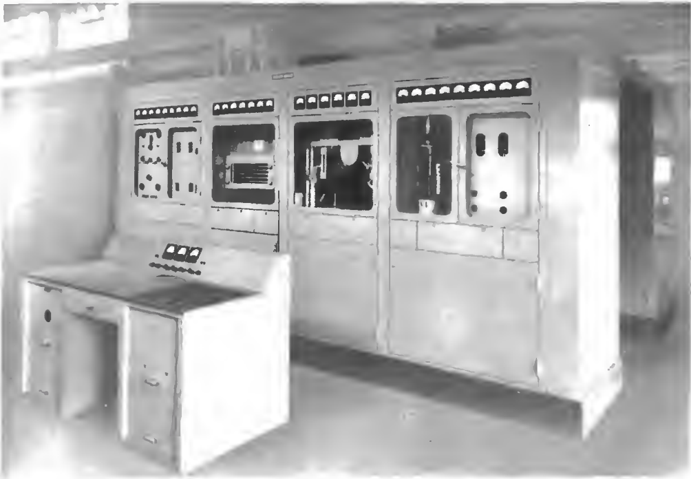
Fig. 1. - Trasmettitore a onde corte universale semi-automatico, da 10 kW in telefonia tipo SO 25/10 K. Gamma della lunghezza d'onda 12,5-90 m. Durata del cambiamento della lunghezza d'onda: 3 minuti. Il trasmettitore può essere messo in servizio dal pulpito di comando. I singoli armadi contengono da sinistra a destra: — gli stadi preliminari ad alta frequenza; — lo stadio finale ad alta frequenza (armadio dei tubi ed armadio del circuito d'uscita); — i tubi dello stadio finale del modulatore; — gli stadi preliminari del modulatore. La fila posteriore degli armadi contiene il trasformatore di modulazione nonchè la parte corrente forte d'alimentazione. In primo piano è visibile il pulpito di comando.
