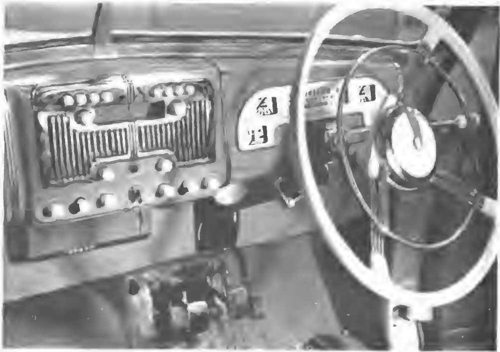
Instollazione di ricevitore radiomobile H M V o onde predisposte.
